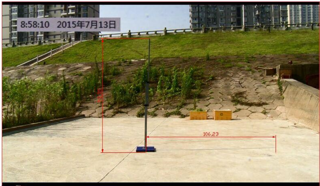
图 3 CAD 测量的影长和杆长
